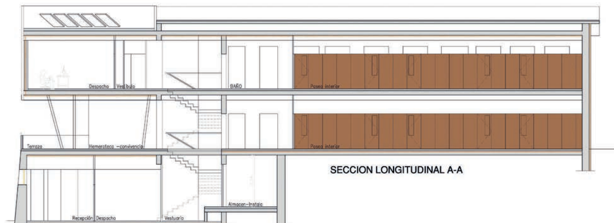
Sección. Los pasillos se forran de DM integrando las puertas o creando armarios entre el muro de carga e iluminación en la parte superior
